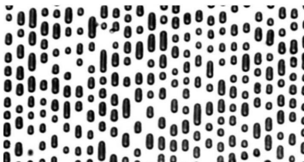
Рис.6. Оптичне зображення поверхні сапфірової підкладки після йонно-променевого травлення крізь двошарову маску - шар позитивного фоторезисту та шар хрому (отримано на мікроскопі NEOPHOT 2).
