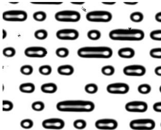
Рис. 5. Зображення поверхні дисків після хімічного травлення шару хрому (зображення двошарової маски на поверхні сапфірової підкладки).
