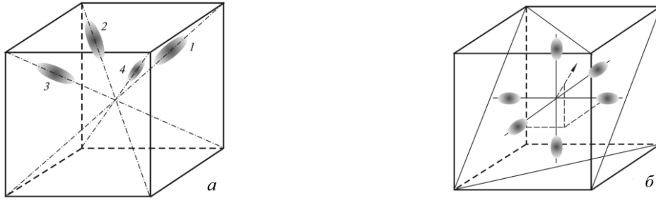
Рис. 1. Форма і розташування поверхонь сталої енергії: a – для чотирьох долин зони провідності, орієнтованих уздовж симетрично еквівалентних кристалографічних напрямків \langle 111 \rangle в n -Ge; б – для шести долин зони провідності, орієнтованих уздовж напрямків \langle 100 \rangle в n -Si.
